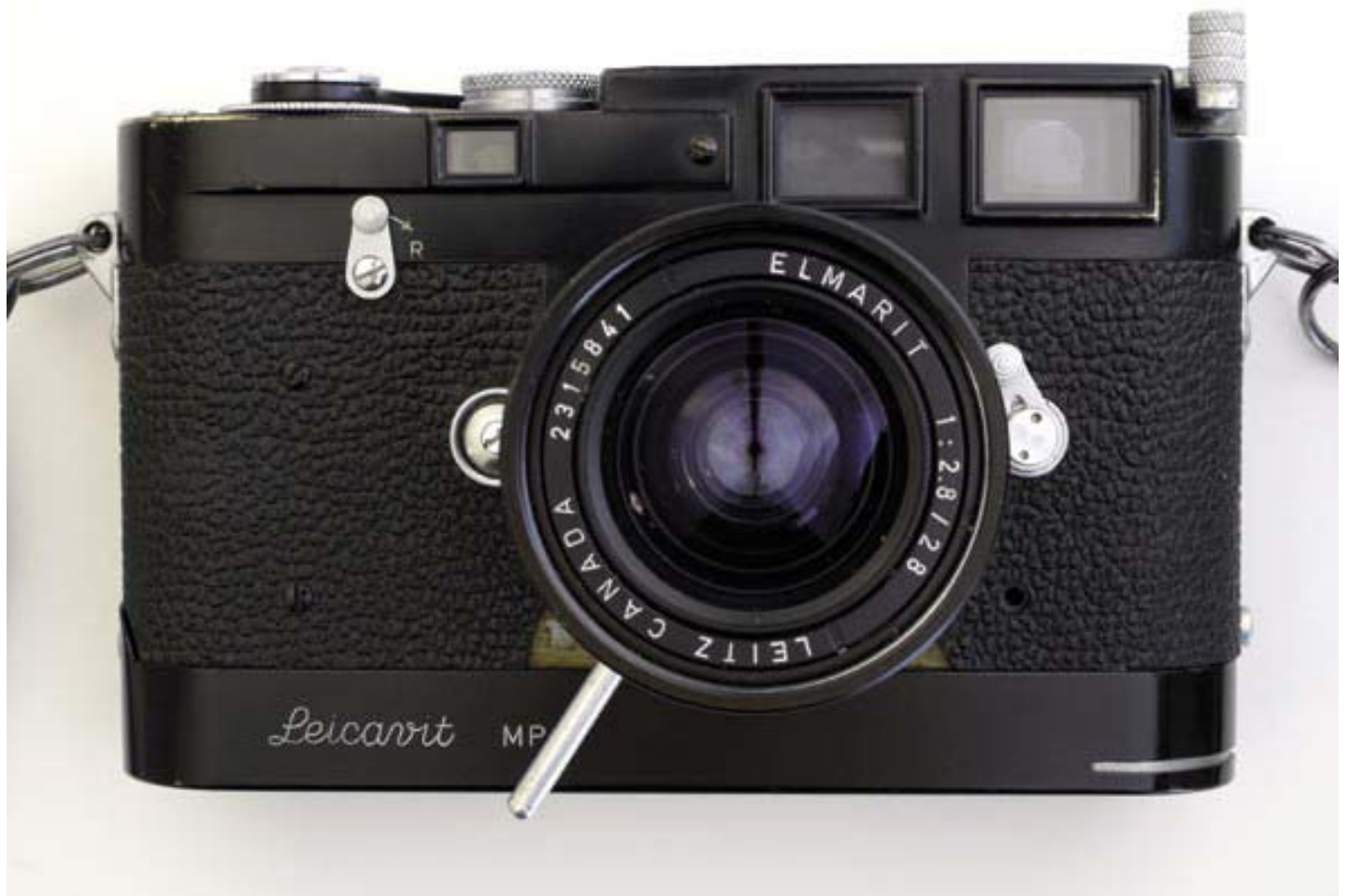
Abb. 9: Die Leica M3D-3. An allen Objektiven liess David Douglas Duncan einen solchen langen Fokussierhebel anbringen.
